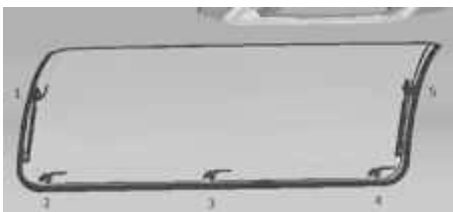
Abb. 37: Innenansicht des gewölbten Ausstellfensters mit fünf Drehriegeln
