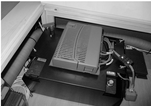
Abb. 70: Batterieabdeckung mit Steuergerät für Mover (optional)
