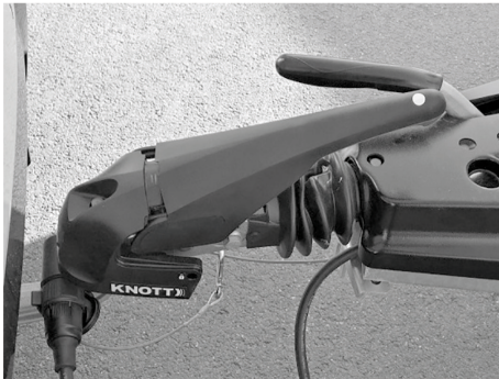
Abb. 10: Zugkugelpkupplung geschlossen, Stabilisierung aktiviert
