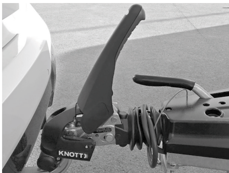
Abb. 9: Zugkugelpkupplung geschlossen, Stabilisierung deaktiviert
