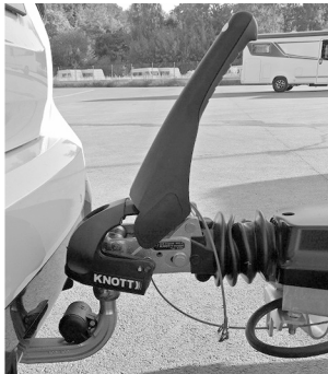
Abb. 13: Zugkugelpkupplung geöffnet, Stabilisierung deaktiviert
