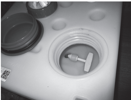
Abb. 99: Ablasstopfen im Frischwassertank
