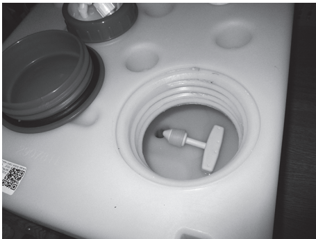
Abb. 109: Ablasstopfen im Frischwassertank
