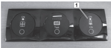
Abb. 94: Ein-/Aus-Schalter der Fußbodentemperierung
