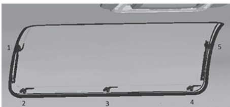
Abb. 28: Innenansicht des gewölbten Ausstellfensters mit fünf Drehriegeln
