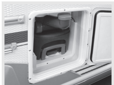
Abb. 50: Fäkalientank mit Spülwasser-Einflussstutzen
