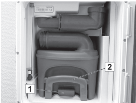
Abb. 199: Fäkalientank im Entsorgungsschacht
